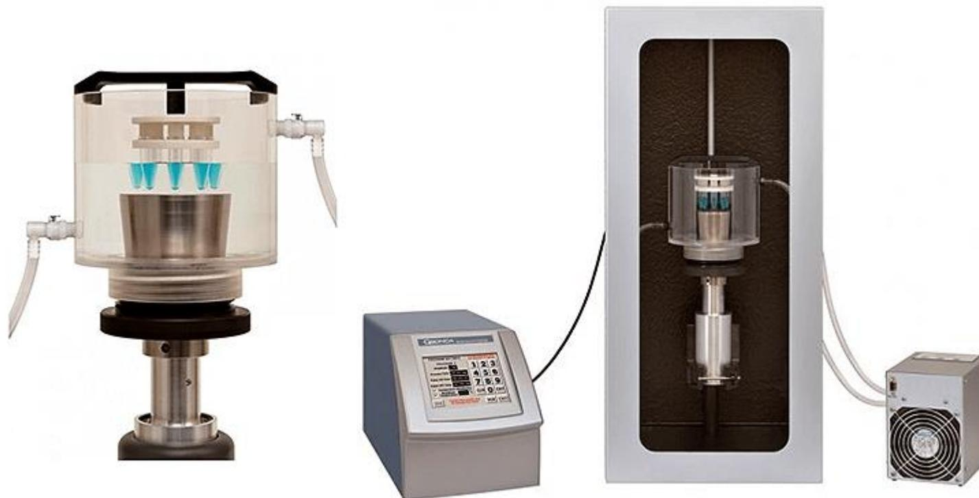
Суть технологии проста: импульс от зонда, расположенного снизу, передается к образцу в пробирке опосредованно, через жидкость (воду), в которую помещена пробирка с образцом. Эта жидкость, помимо передачи импульса, осуществляет функцию термостатирования образцов, оберегая чувствительные макромалекулы от излишнего перегрева. Данное решение позволяет измельчать до 12 образцов одновременно в одинаковых условиях.
